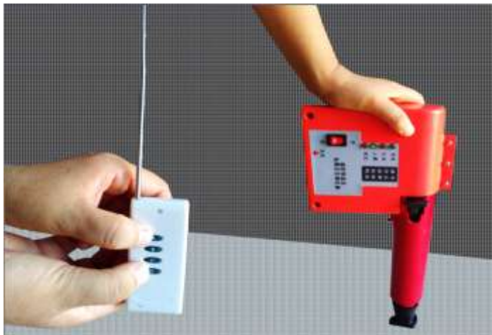
图4 刺扎器不装弹空载试验操作
