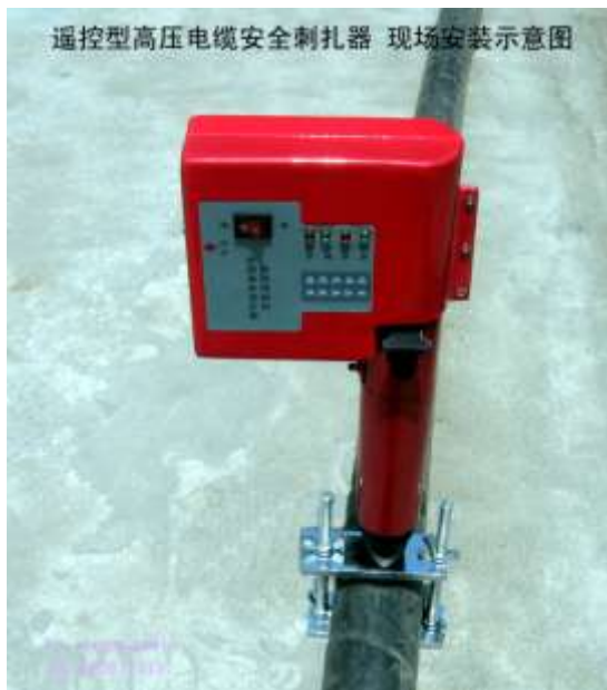
图 8 刺扎器现场安装图
